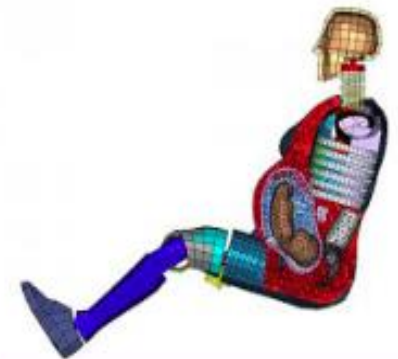
福斯汽車公司的「Linda」是工程師Laura Thackray於2002年為真實16歲車撞擊試驗用孕婦假人而設計的。「Linda」可以模擬高速撞擊對子宮、胎盤和胎兒的影響。
